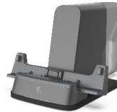
Workstation-Dock mit HDMI, RJ45, USB-A, 3,5 mm Audio. Benötigt Netzteil und Daten- und Netzkabel
